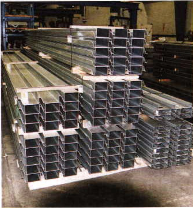
Kleine Auswahl an gekanteten Profilen aus Blechen.
