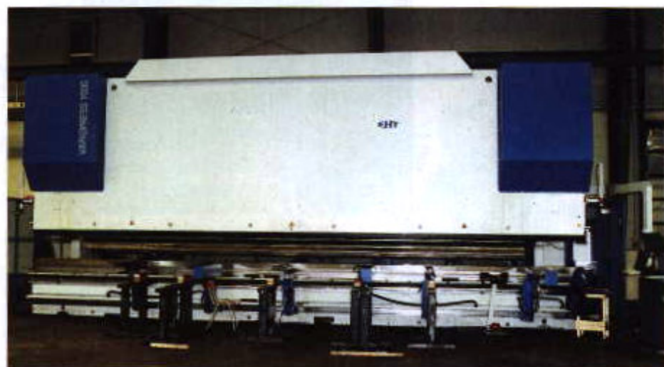
Gesekbiegepresse «Variopress 1000-100» mit einer Presskraft von 10 000 kN und einer nutzbaren Arbeitslänge von 10 050 mm.
