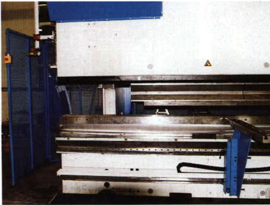
Die links oben am Stößel angebrachte zusätzliche Schutzvorrichtung «Lazer Safe» wird je nach Werkzeughöhe auf den Gefährdungsbereich eingestellt.
